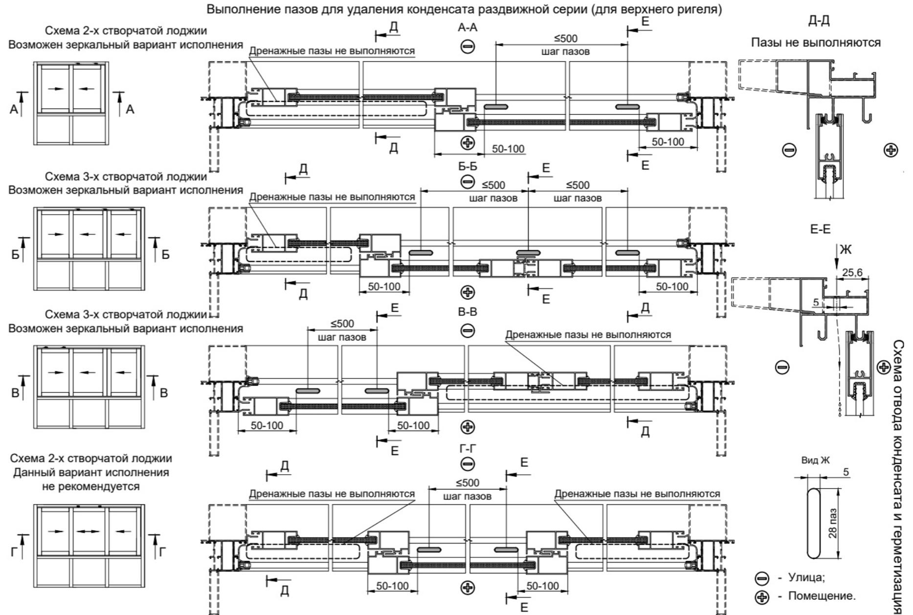
Схема отвода конденсата и герметизация
